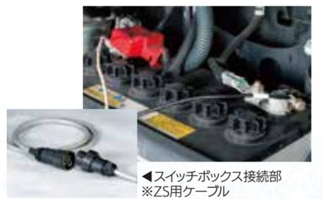
電動だから静かでクリーンな作業ができます。バッテリーへの配線も簡単に着脱できます。
