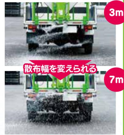
道路幅に応じて手元のスイッチボックスで3m~7mの無段階可変ができます。
